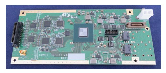
基板はアナログ信号を処理する波形処理回路、デジタル信号変更回路、およびデジタル信号を処理する FPGA により構成されている。
